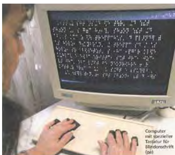
Computer mit spezieller Tastatur für Brailleschrift
