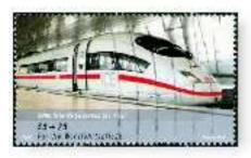
Der Elektratriebzug ICE 3 (BR 403) ist ein Hachgeschwindigkeitzug der Deutschen Bahn. Mit einer zugelassenen Hächstgeschwindigkeit von bis zu 330 km/h ist es der schnellste Reisezug in Deutschland. Im regulären Betrieb erreicht er in Deutschland planmäßig bis zu 300 km/h und in Frankreich 320 km/h.
